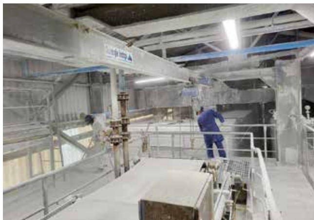
Proizvodnja titanovega dioksida, stiskalnica za ožemanje gela.
