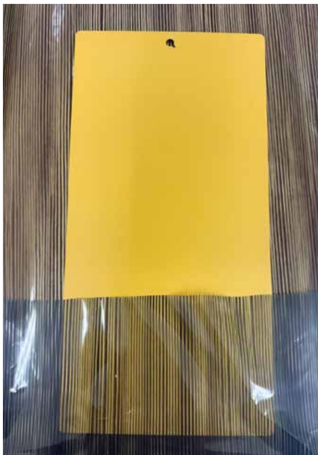
Folija z odtisnjenim vzorcem in polakirana aluminijasta ploščica pred sublimacijo.
