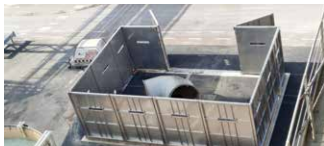
Ureditev novega mesta za visokotlačno pranje, ki omogoča varnejše odstranjevanje gume z gumiranih kosov ter zmanjšuje vplive na okolje.
